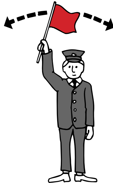
Figur 21b Flaggan förs utvecklad flera gångar fram och åter i sid- led.
