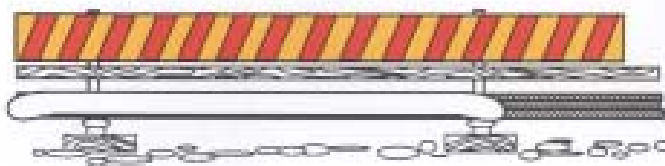
Figur 44 Varningsmarkering vid uppfångningsskena (s.k. sidoplåt).
